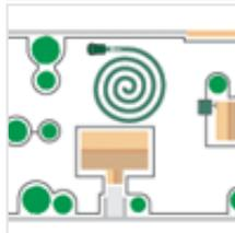
**Spiral-Mähsystem:** Bei grösseren Flächen optimiert der Ambrogio seine Schnittweise: Er sucht sich das hohe Gras und mäht dort spiralförmig- dadurch erhöht er seine Flächenleistung markant.
